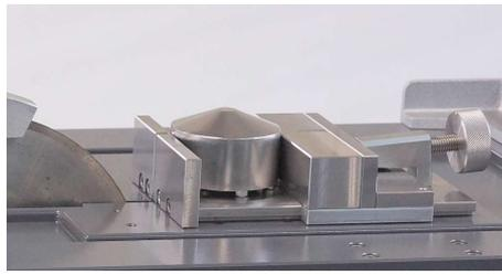
専用バイスダブルのクランプ例
