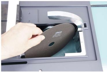
砥石交換（専用バイス装着時）
