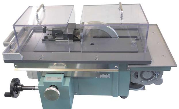
長尺試料加工時の前後カバー
